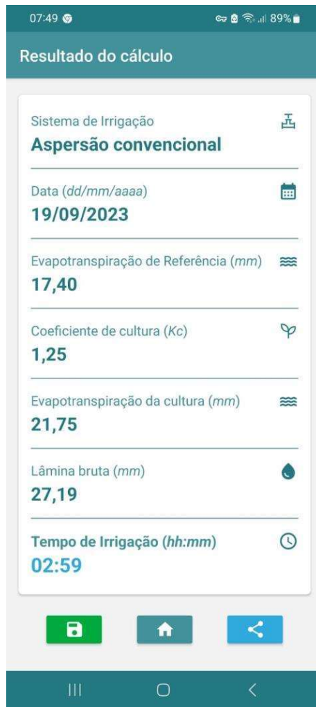
Figura 22. Resultados calculados no aplicativo, com inserção do valor de E_{T0} , para o sistema de Aspersão convencional
