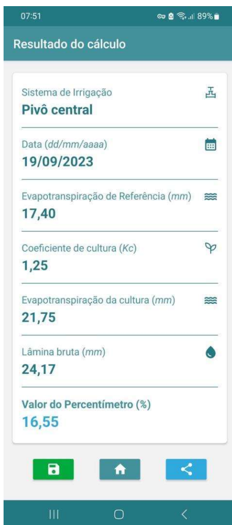
Figura 23. Resultados calculados no aplicativo com inserção do valor de ETo, para o sistema de Pivô Central.
