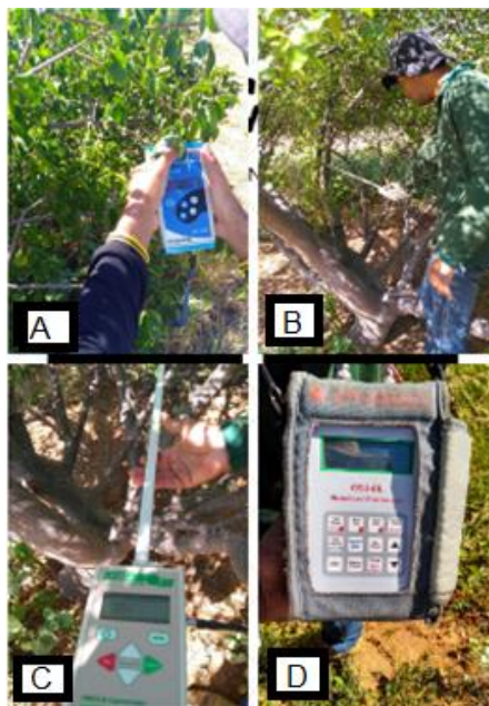
Figura 4. Medidor de clorofila, Clorofilog CFL 1030 Falker ® (A); coleta com aparelho AccuPAR, modelo LP PAR 80 para Índice de área foliar (B); aparelho AccuPAR, modelo LP PAR 80 (C); e fluorômetro portátil de luz modulada, OPTI-Sciences modelo OS1-FL, Hudson, USA (D). Fotos: Diogo Barreto Magalhães
