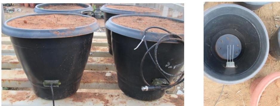
Figura 1 – Baldes de PVC preparados com sensores de TDR e Brita.
