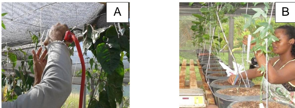
Figura 2 - Avaliações das trocas gasosas realizadas com o analisador de gás a infravermelho (IRGA) modelo Lcpro+® Portable Photosynthesis System (ADC BioScientific Limited, UK) com temperatura e irradiância ambiente e fluxo de ar de  $200 \text{ ml min}^{-1}$  (A) e leituras das características fitotécnicas (B). Guanambi, BA, 2016.
