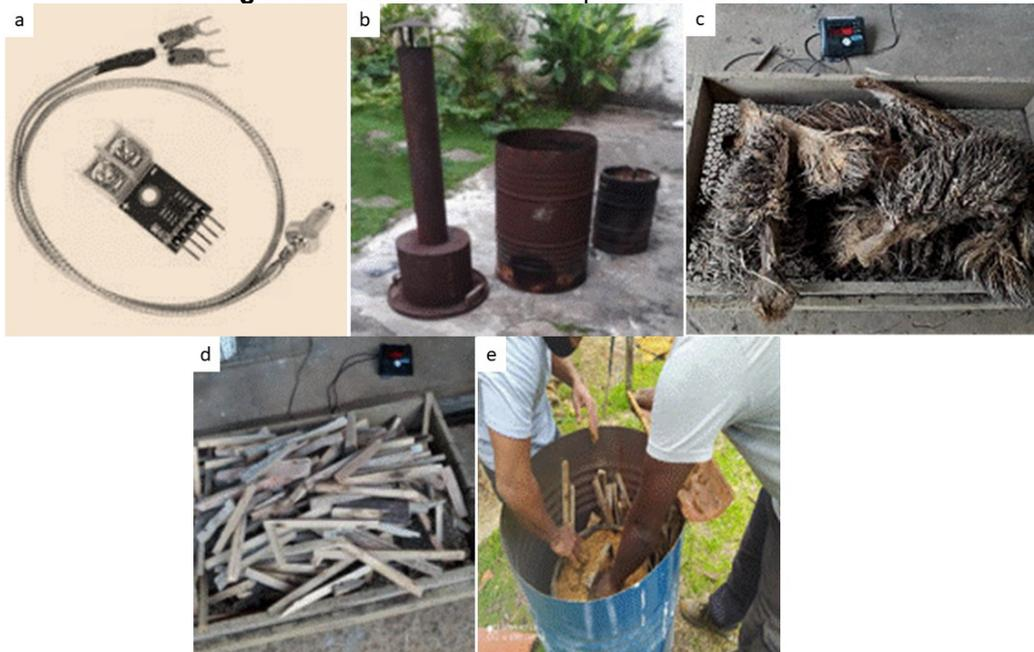
a-Termopar tipo K, b-forno de pirólise, c-bucha de dendê, d-madeira de pinus, e-barro
