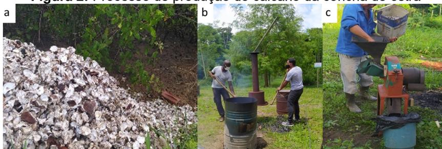
a- Concha de ostra depositada em manguezais. b- Forno c- Processo de trituração
