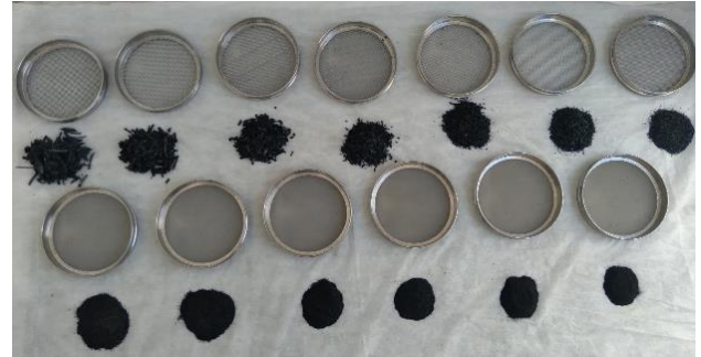
Figura 11F. Granulometria do biocarvão da biomassa de Nim
