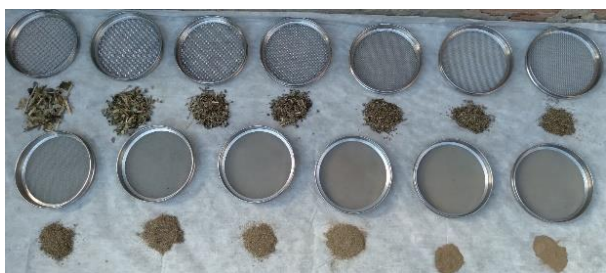
Figura 11C. Granulometria da amostra de biomassa de Jurubeba
