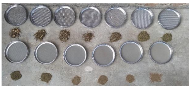
Figura 11A. Granulometria da amostra de biomassa de da Jurema
