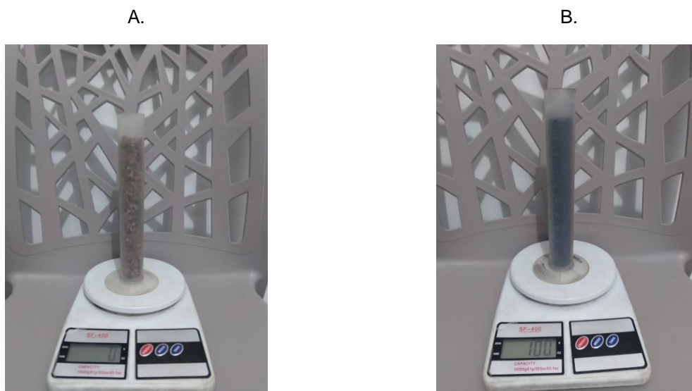
Figura 12. Medida de densidade do resíduo (A); e medida de densidade do biocarvão (B)
