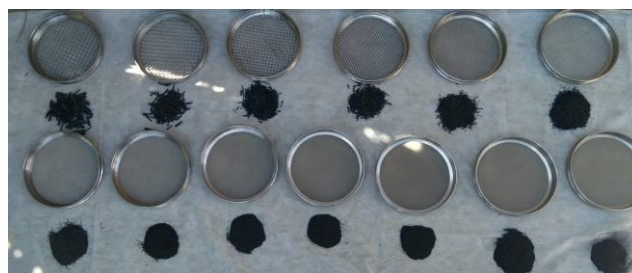
Figura 11D. Granulometria do biocarvão da biomassa de Jurubeba
