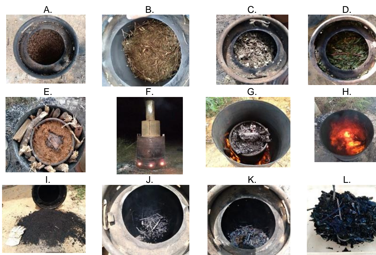
Figura 7. Adição de resíduo de sisal no tambor de chopp (A); adição de biomassa de Jurema no tambor de chopp (B); adição de biomassa de jurubeba no tambor de chopp (C); adição de biomassa de nim no tambor de chopp (D); inserção de material de combustão na câmara de ignição e vedação com barro (E); forno em processo de pirólise lenta para a carbonização das biomassas (F, G, H); produção de biomassa pirolisada do resíduo de sisal (I); produção de biomassa pirolisada de jurema (J); produção de biomassa pirolisada de jurubeba (K); e produção de biomassa pirolisada de nim (L)
