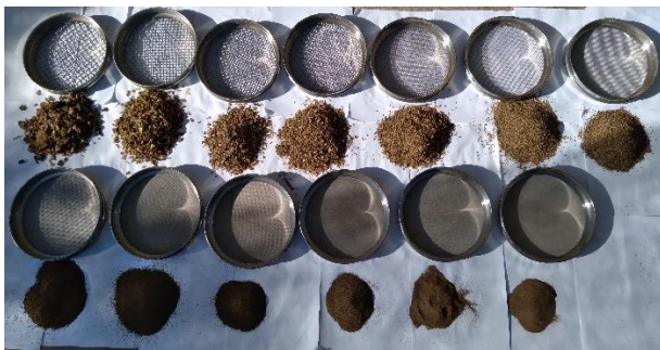
Figura 11G. Granulometria da amostra de biomassa de Resíduo de sisal
