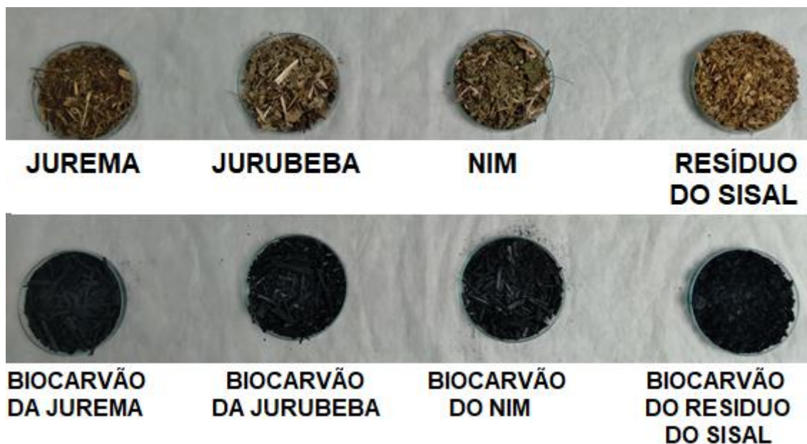
Figura 8. Biomassas antes e após a carbonização lenta
