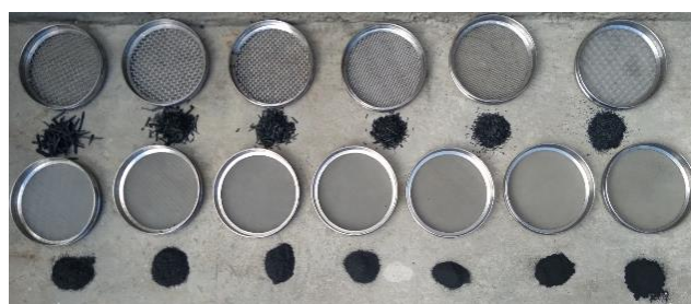
Figura 11B. Granulometria do biocarvão da biomassa de Jurema
